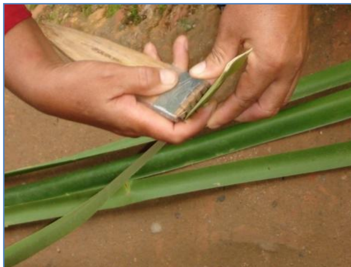
ภาพที่ ๖ การใช้มีดจักซี่กรีดใบเตยหนามเพื่อให้ได้ขนาดตามต้องการ
